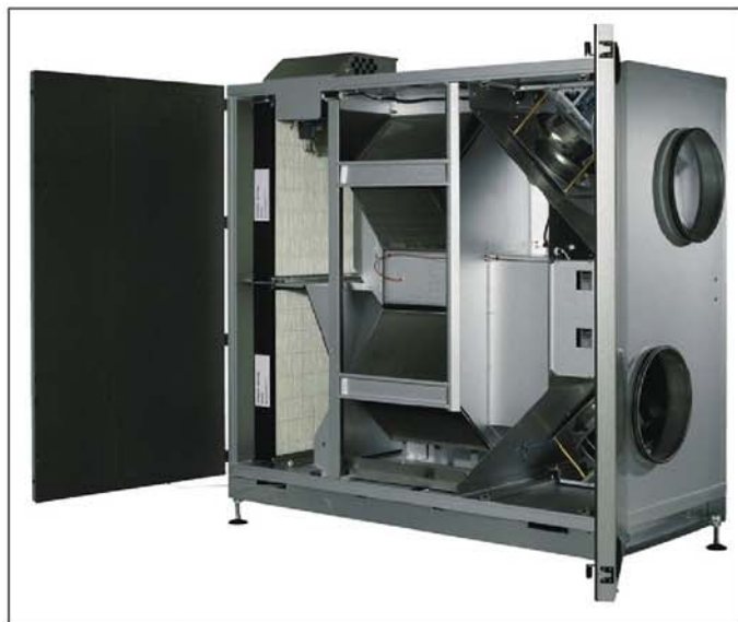
Figur 6. For at sikre høj virkningsgrad og lavt specifikt elforbrug er vist et aggregat udstyret med modstrømsveksler og optimerede luftveje. Derfor er aggregatet noget større, end vi er vant til at se på markedet.
