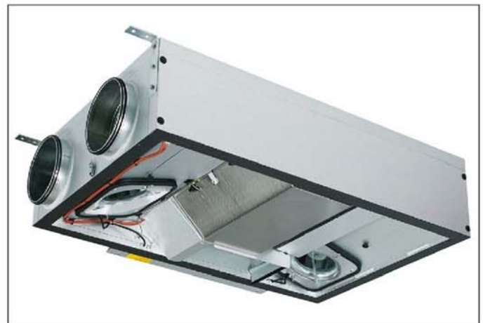
Figur 5. Aggregater udviklet specielt til det tyske marked, hvor man ønskede en høj virkningsgrad og samtidig et lavt aggregat, der kan indbygges over et nedhængt loft. Luftmængde fra ca. 500 m 3 /h til ca. 1300 m 3 /h.
